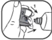
Pomocou otvoru na bočnej strane aplikátora odstráňte membránu v tvare hviezdy z tuby.
